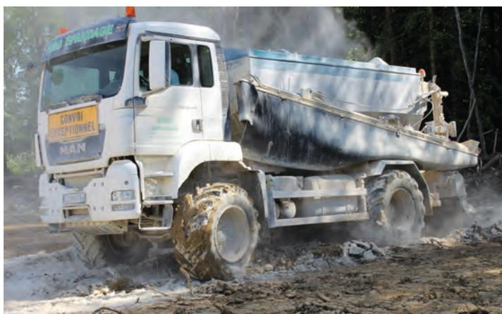
Terrain particulièrement humide, afin d'apporter de grandes quantités de chaux par m<sup>2</sup>, la rampe ne fait que la largeur du camion.
